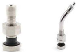
Toutes les roues Alcoa® Wheels sont montées avec des valves nickelées, sauf les roues de 22,5" x 17,00". Le revêtement nickelé, le joint spécial en T noir et la rondelle en plastique de l'écrou hexagonal réduisent le risque de corrosion galvanique entre la valve et la roue.
